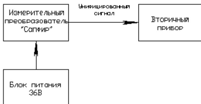
Рисунок 2.9 - Структурная схема измерения давления измерительным преобразователем «Сапфир»
