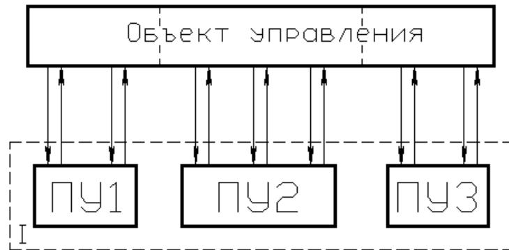
Рисунок 2.2 – Структурная схема одноуровневой децентрализованной системы управления: ПУ1, ПУ2, ПУ3 – пункты управления
