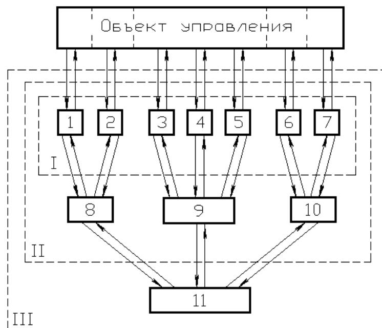
Рисунок 2.4 – Пример структуры трехуровневой АСУ ТП: 1-7 – пункты управления 1-ого уровня; 8-10 – пункты управления 2-ого уровня; 11 – пункт управления 3-его уровня
