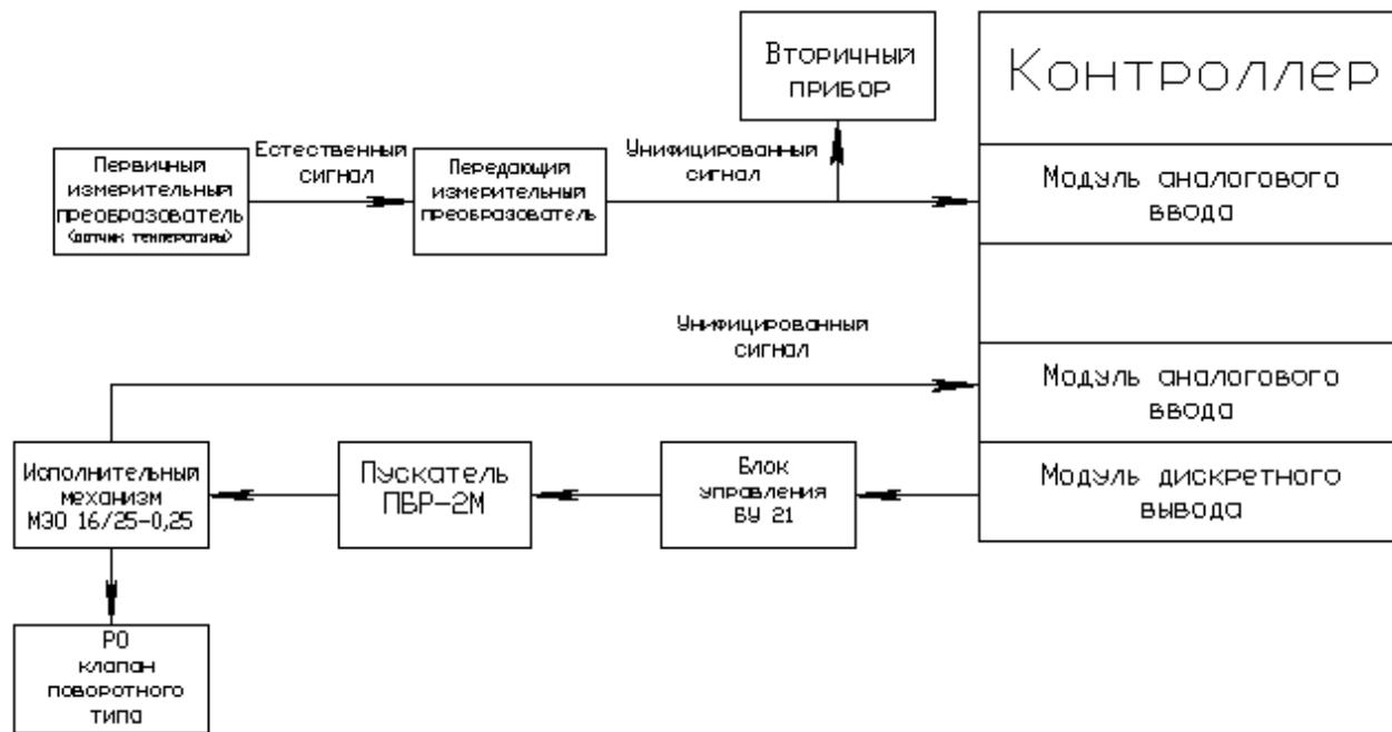
Рисунок 2.11 – Контроль и регулирование температуры с применением контроллера
