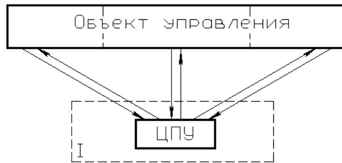
Рисунок 2.3 – Структурная схема одноуровневой централизованной системы управления
