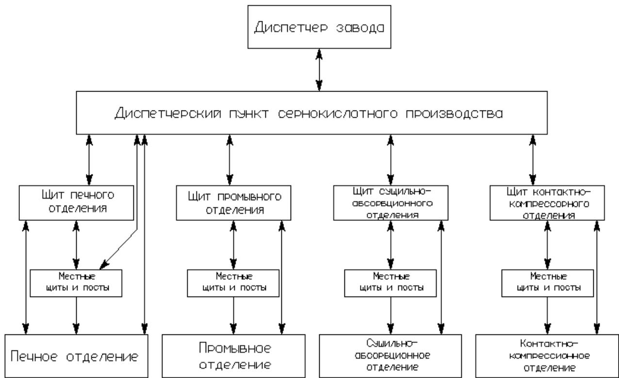
Рисунок 2.1 - Структурная схема контроля и управления сернокислотным производством
